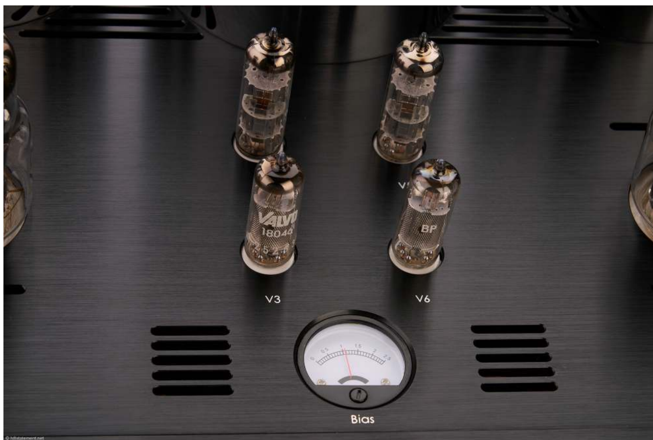
Vorne die beiden Eingangsröhren 18046 von Valvo, eine für die Deutsche Post entwickelte Niederfrequenz-Leistungspentode. Dahinter die beiden PCL86 Ver-bundröhren, die jeweils ein Trioden- und ein Pentodensystem in sich vereinen, im Einsatz als Treiberröhre
