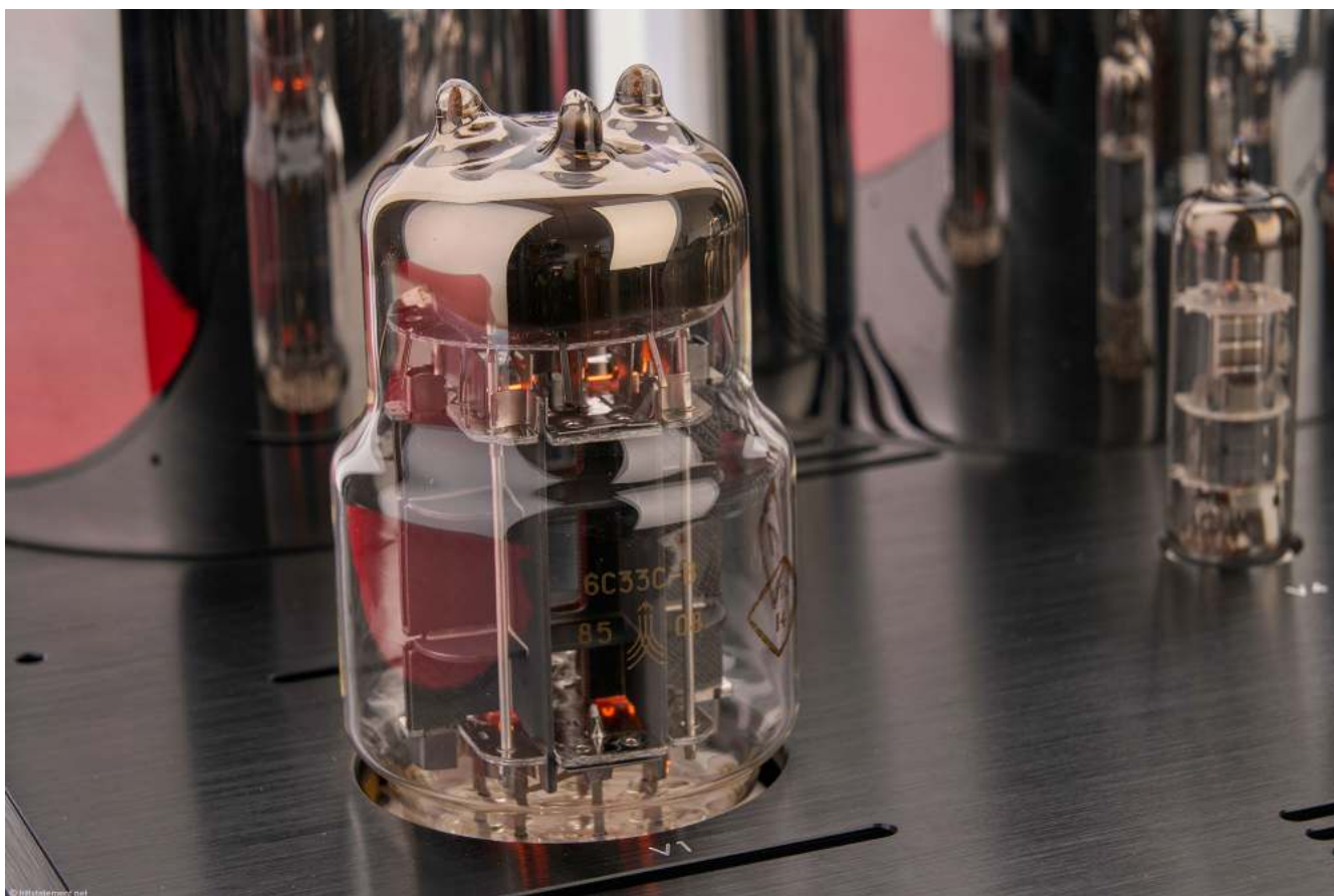
Das Herzstück und Schmankerl dieses Verstärkers ist die 6C33 Doppeltriode mit parallel geschalteten Elektroden und getrennten Heizfäden. Diese robuste, für Militärzwecke entwickelte NOS-Röhre stammt aus dem russischen Ulyanovsk-Röhrenwerk
